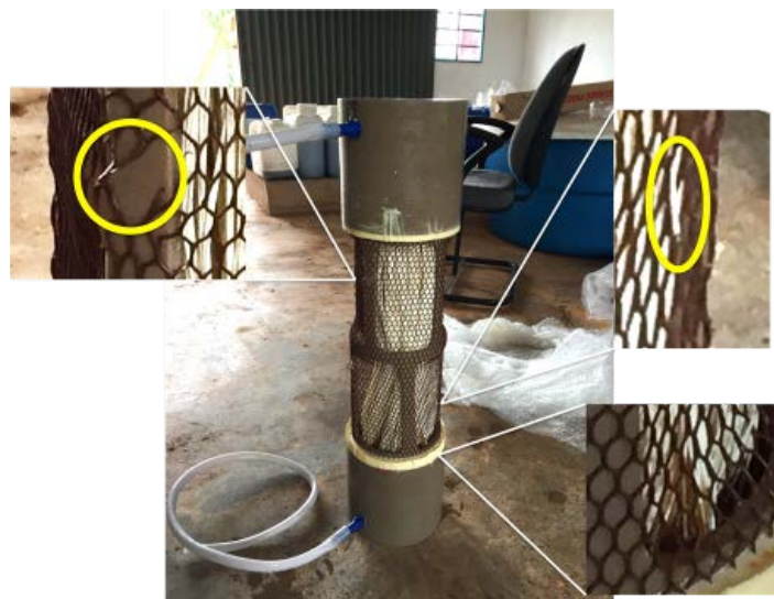
Figura 4 - Módulo de membrana com indicação de possíveis problemas de integridade
