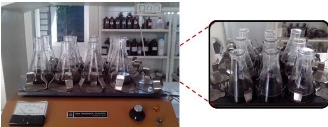
**Figura 1. Experimento de hidrólise alcalina para os lodos estudados.**
