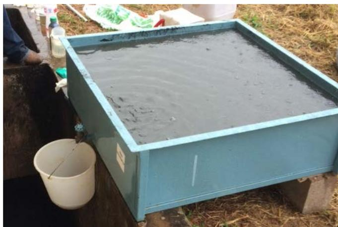
Figura 2 - Leito piloto com inclinação para escoamento através do registro.
