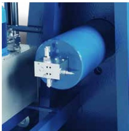
Válvula de bloqueio de um filtro prensa Overhead AE
