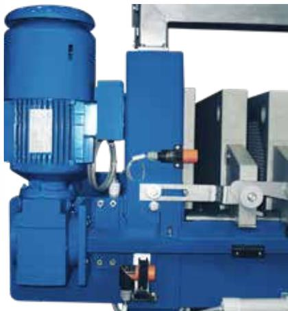
Dispositivo opcional de vibração para rápida descarga da torta de filtração, reduzindo os tempos de ciclo
