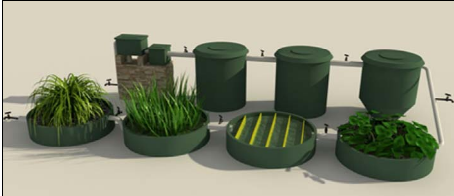
Figura 1: Planta do sistema compacto de tratamento descentralizado de esgoto doméstico, Ecosistema Engenheirado (EE), composto por 9 tanques: Caixa controladora de vazão; Caixa de gordura; Fossa séptica; Filtro aerado submerso; Decantador secundário (Filtro anóxico); e Tanques vegetados com aguapé, algas, macrófita emergente e gramínea respectivamente. Fonte: Salomão (2010).
