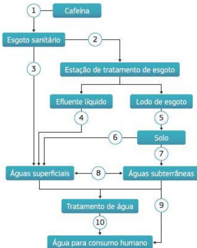
**Figura 3.** Rotas de transporte de cafeína a partir do seu descarte em sistema de esgoto sanitário. Fonte: Canela et al. (2014).
