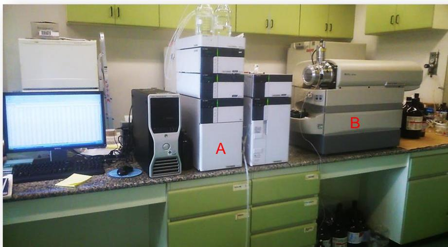
**Figura 15.** Cromatógrafo Líquido de Alta Eficiência, Shimadzu, modelo Proeminence UFLC (A) e espectrômetro de massas 3200 Q TRAP Applied Biosystems (B).
