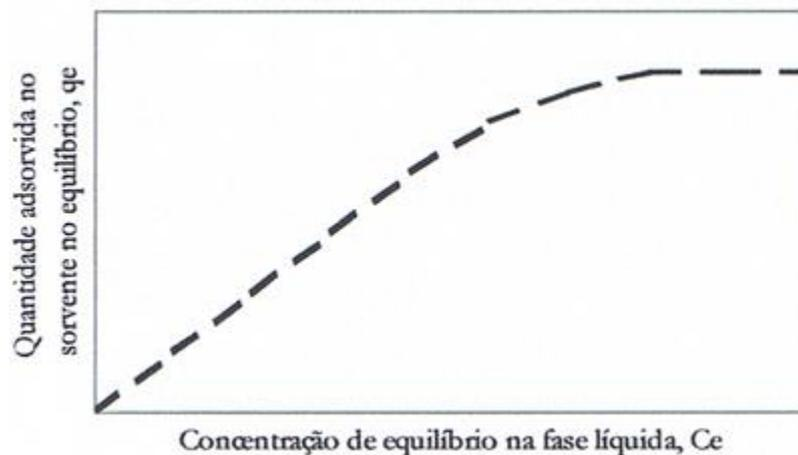
**Figura 1.3:** Representação esquemática da Isotérmica de Langmuir (Brás, 2005)
