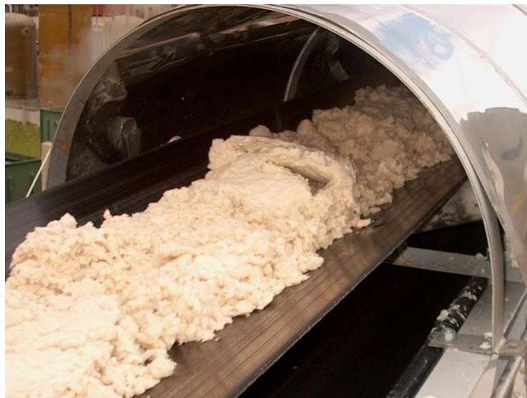
Polpa sendo transferida a mais de 10% de consistência por correia transportadora
