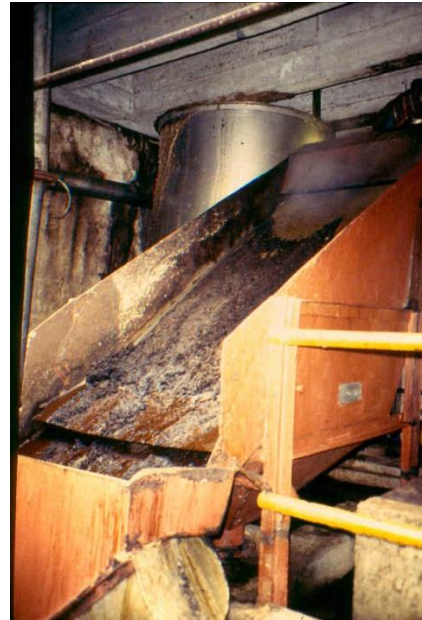
Efluente fibroso e peneira simples para recuperar fibras em fábrica de papel
