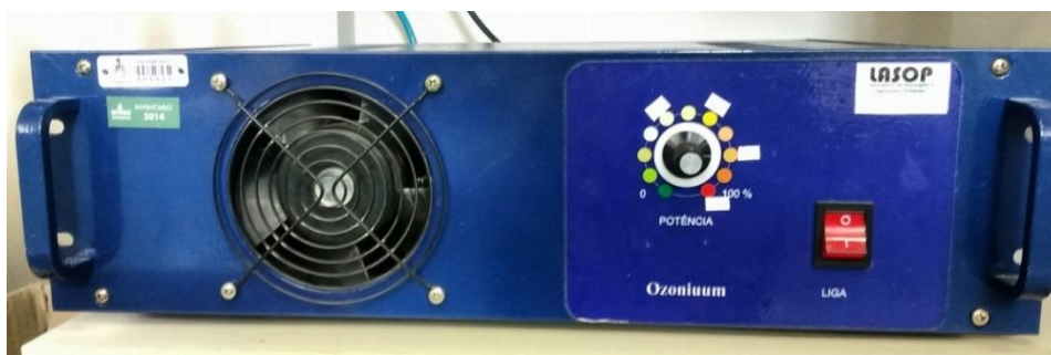
Figura 3.5: Ozonizador utilizado nos experimentos no LASOP.
