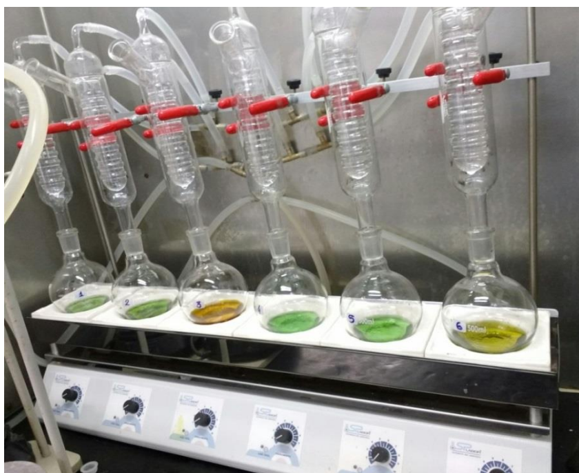
Figura 3.3: Digestor utilizado para análise de DQO no laboratório da empresa.
