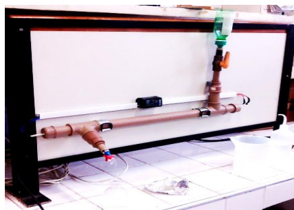
Figura 2. Protótipo do sistema de desinfecção por radiação UV
