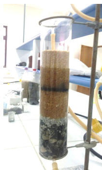
Figura 1. Protótipo do sistema de filtro em coluna com carvão ativado. Autor do Trabalho.
