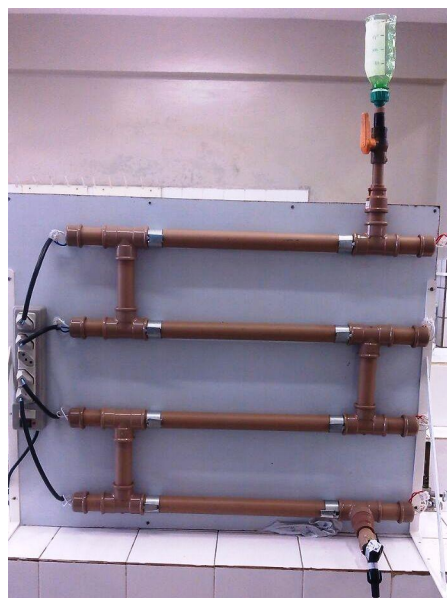
Figura 3. Protótipo do sistema de desinfecção por radiação UV. Autor do Trabalho.
