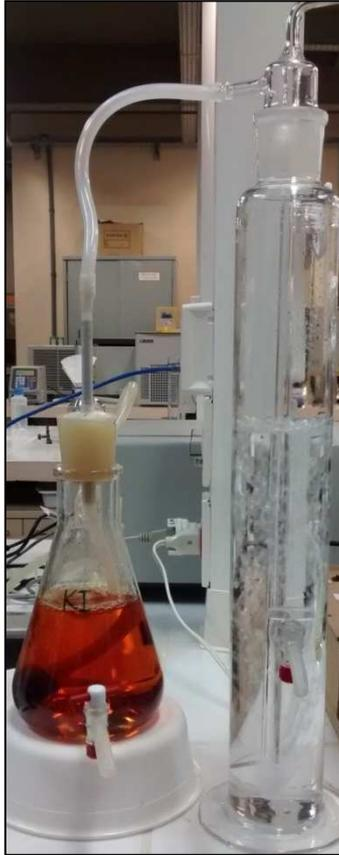
**Figura 17.** Coluna de contato e frasco lavador utilizados nos experimentos.
