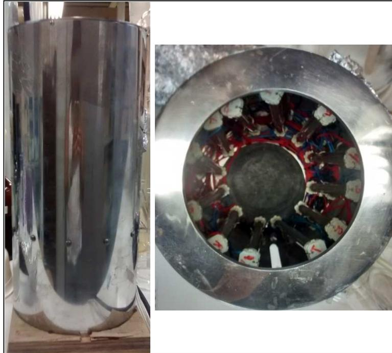
**Figura 18.** Reator de UV utilizado nos experimentos.
