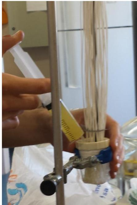
O conjunto ficou em repouso mais 24 horas para a cura da resina, que então foi quebrada na borda da redução de PVC. Este procedimento teve por objetivo retirar a resina fazendo com que as membranas não se compactem na região de sucção e o conjunto fique inteiramente vedado.
