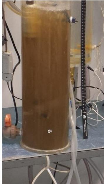
As condições de mistura necessárias para formação e precipitação dos flocos são bem específicas (LIBÂNIO, 2010) e o tanque T3 não foi projetado para que houvesse coagulação/floculação da matéria orgânica e sim uma condição de permeação sob aeração por borbulhamento.
