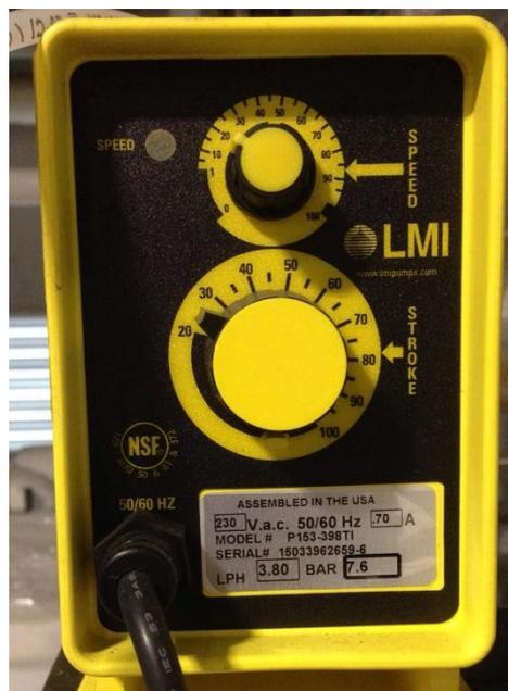
Após o ajuste, a vazão de injeção de coagulante foi medida pelo método de cubagem, utilizando uma proveta de 20 mL graduada com medição de tempo utilizando relógio com cronômetro.
