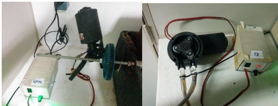
Figura 6. Bomba controladora de vazão (6b) e motor controlador de velocidade de rotação (6a). Fonte: autor.
