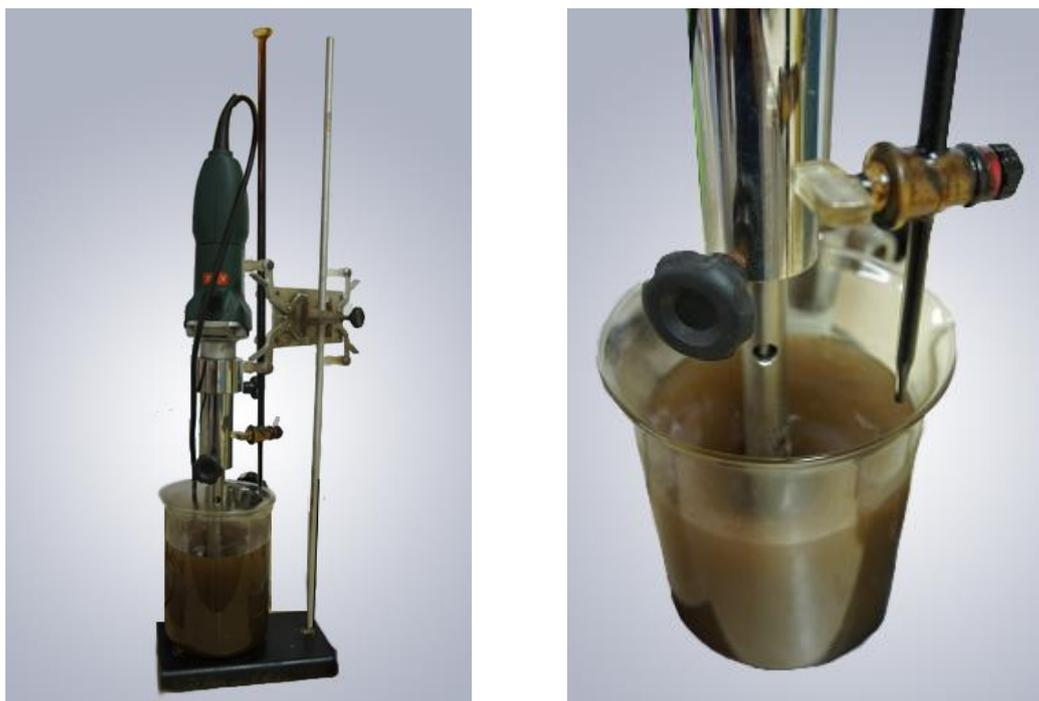
Figura 8. Emulsificador Ultraturrax (à esquerda) e detalhe do gotejamento e emulsificação do óleo em água (à direita).
