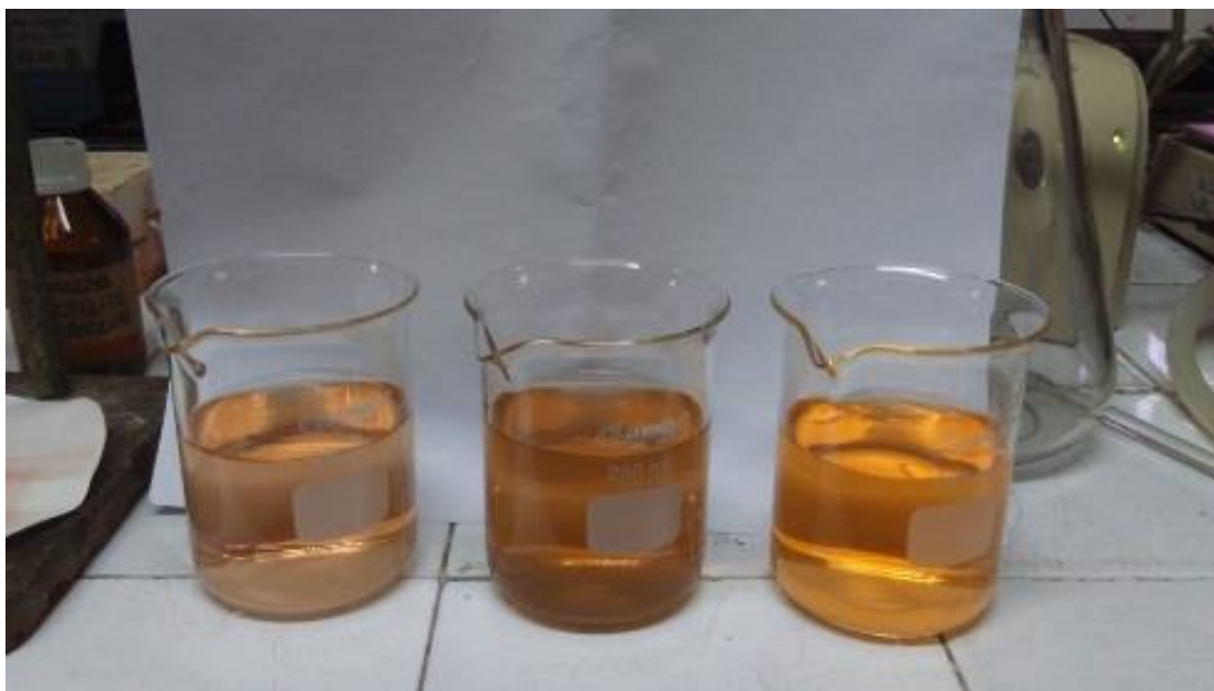
FIGURA.16- Amostras com concentrações altas do oxidante, a remoção é visivelmente evidente e observável depois dos primeiros 3 horas da degradação.
