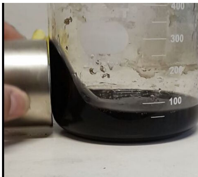
Figura 23. Resposta magnética das nanopartículas de magnetita em meio aquoso.
