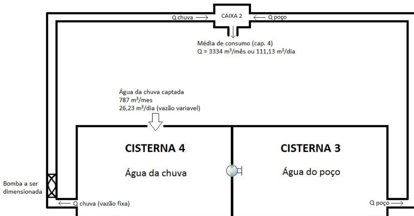
Figura 24 - Esquema gráfico do bombeamento da água da chuva
