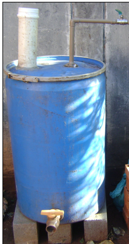
Figura 2. Foto do biodigestor montado e em funcionamento
