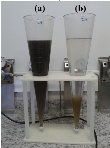
Figura 49. EB (a) e EP (b) após tratamento em dia ensolarado, depois de 60 minutos de sedimentação no cone Imhoff.
