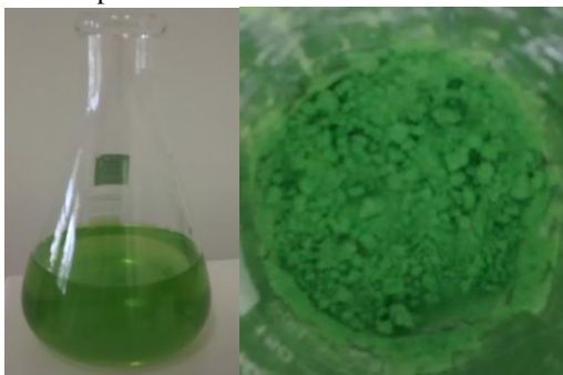
Figura 5. Complexo ferrioxalato nas formas dissolvida e sólida.
