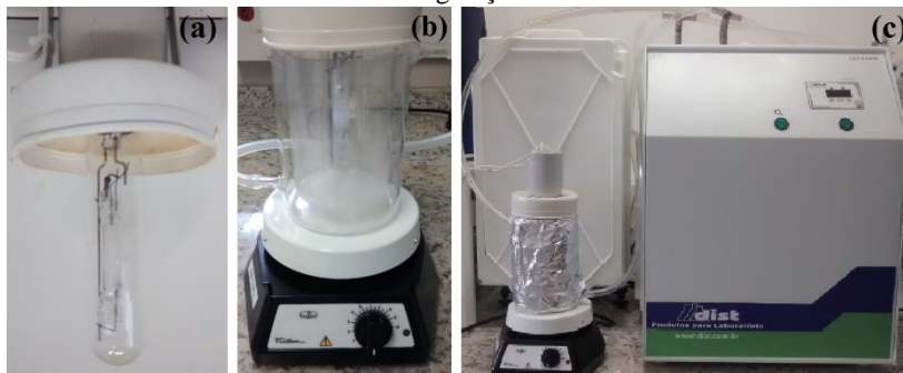
Figura 8. Reator com lâmpada UV. Destacando: (a) lâmpada envolta por tubo de quartzo; (b) frasco com parede dupla de vidro Pyrex com lâmpada inserida e agitação magnética; (c) reator revestido de alumínio conectado ao sistema de refrigeração.
