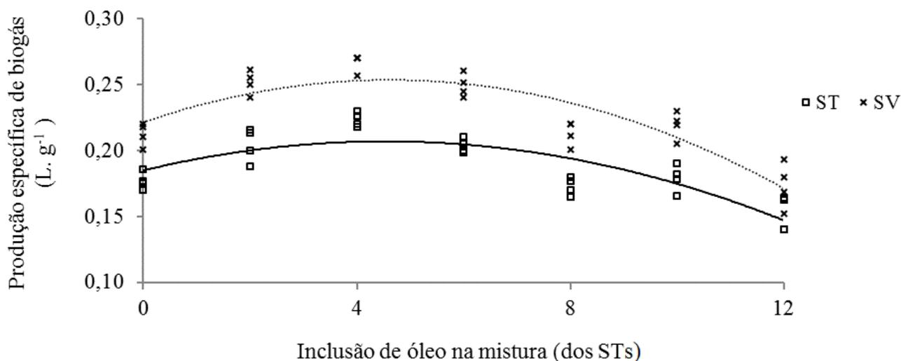
FIGURA 3. Produções específicas de biogás (L. g<sup>-1</sup> de ST e SV adicionado) a partir de substratos preparados com os dejetos de bovinos e doses de inclusão de óleo de descarte. **Biogas specific production (L g<sup>-1</sup> of added ST and SV) of substrates composed of dairy cattle manure and increasing rates of waste oil.**
