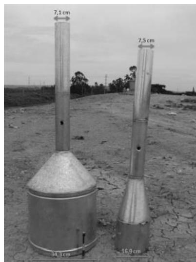
**Figura 12:** Adaptadores para medição da velocidade do biogás
