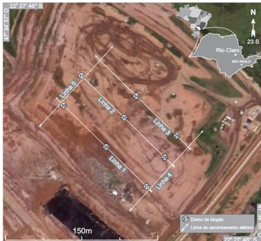
**Figura 13:** Localização da área de estudos, com posição das linhas de aquisição de dados geofísicos e drenos de medida da vazão de biogás
