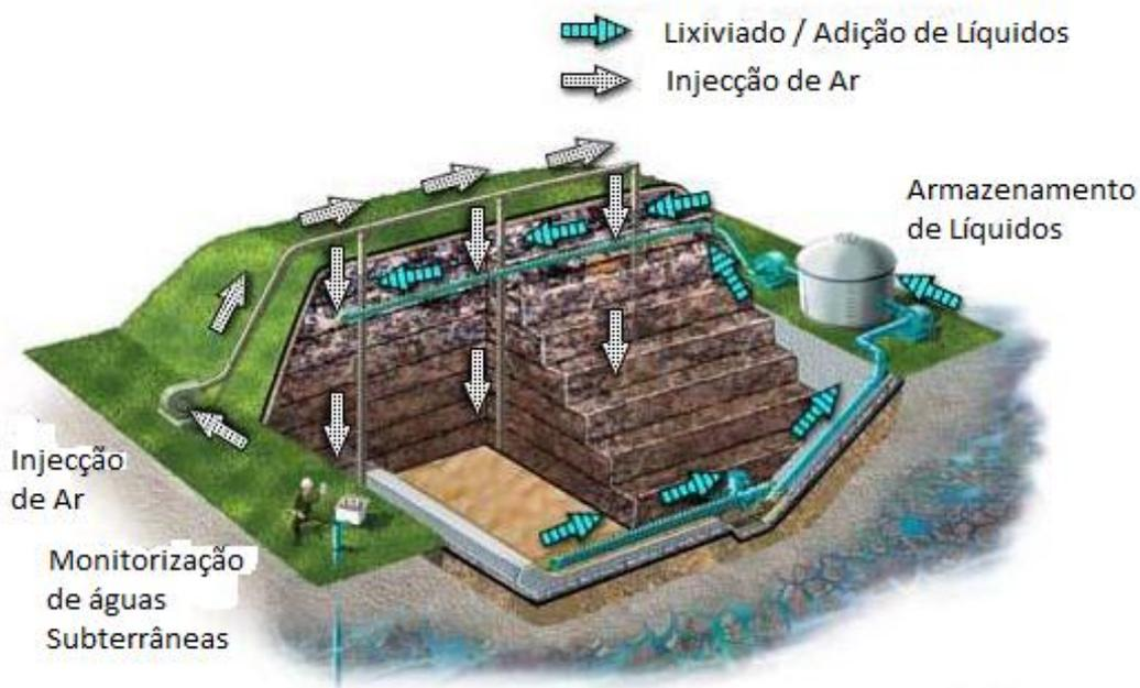
Figura 2.5 Aterro com bioreactor aeróbio (adaptado de U.S.EPA 2004).
