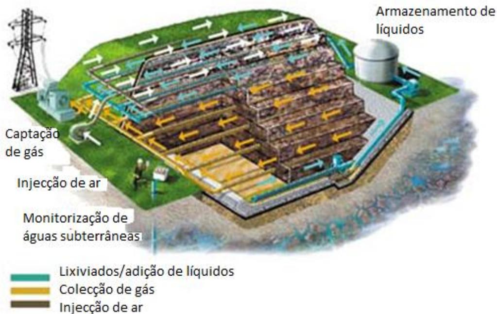
Figura 2.6 Aterro com bioreactor aeróbio-anaeróbio (adaptado de U.S.EPA 2004).
