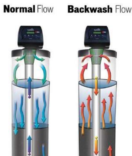
Fig. 08 Fluxos na Operação e Regeneração (uswatersystems, 2016)
