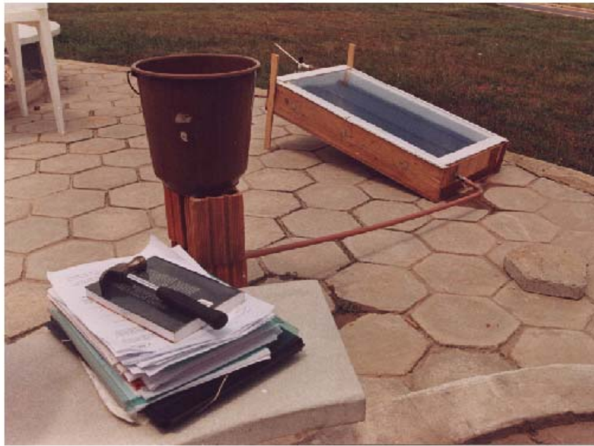
FIGURA 4.2 – Medida da temperatura do coletor solar plano
