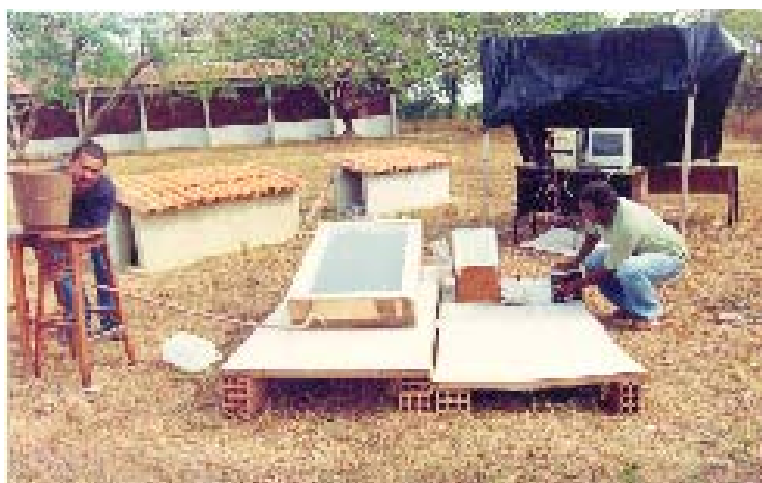
FIGURA 5.9 – Ensaio do dessalinizador solar híbrido
