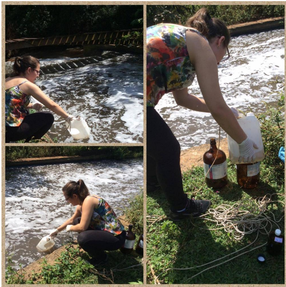
Figura 4 - Imagens da coleta de efluente na estação de tratamento de esgotos de Araraquara (Rodovia SP 255 às margens do Ribeirão das Cruzes).
