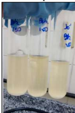
Figura 8- Tubos de Lauril com suspeita de coliformes totais
