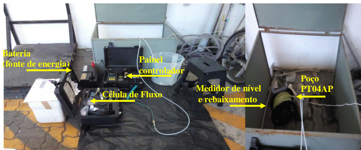
Figura 2 - Sistema automatizado de amostragem de água subterrânea Low-Flow Sampling montado no poço PT04AP
