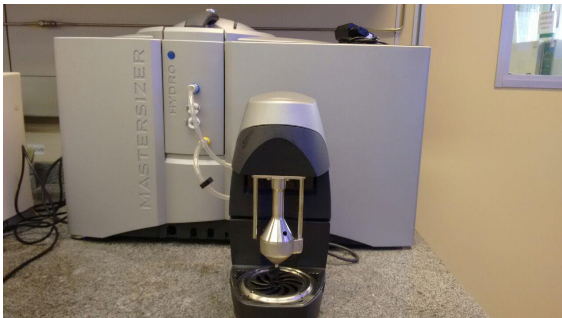
Figura 16- Imagem do equipamento Malvern Master Sizer 3000 E – utilizado na determinação do tamanho das partículas.
