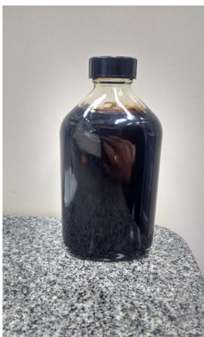
Figura 14- Imagem da amostra de petróleo utilizada no preparo das amostras sintéticas de água produzida.
