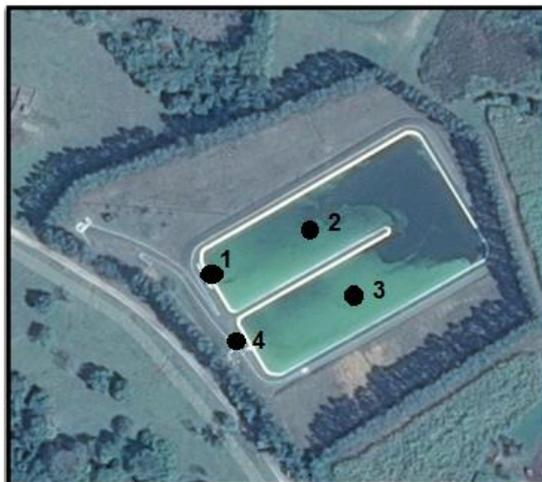
**Figura 9.** Pontos de monitoramento da etapa 1. (1- Afluente ou entrada da ETE; 2 - Meio da primeira seção; 3 – Meio da segunda seção; 4 – Saída ou efluente tratado).
