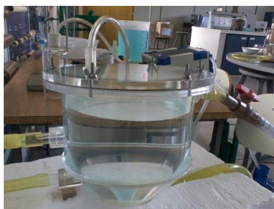
Figura 2 – Fotografia do RALF de bancada utilizado nos ensaios hidrodinâmicos
