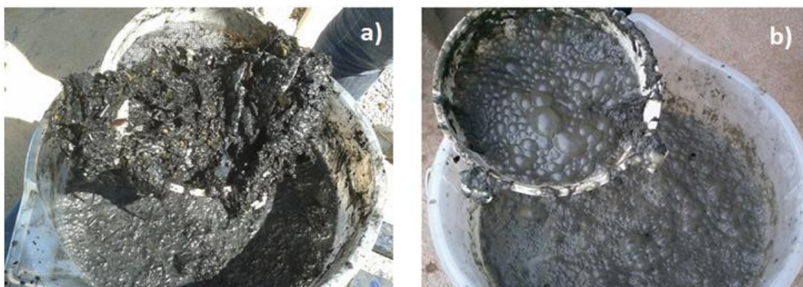
Figura 12 – Aspecto visual da espuma no Reator Convencional. (a) espuma gerada com desarenador desativado. (b) espuma gerada com desarenador ativado.
