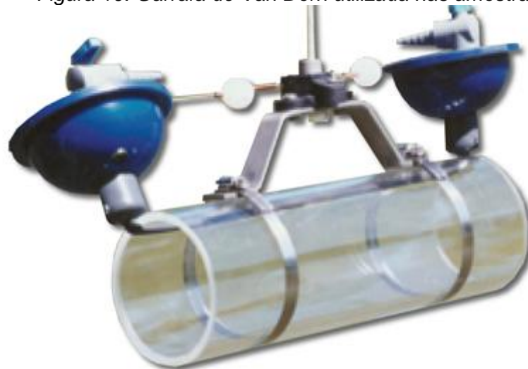
Figura 10. Garrafa de Van Dorn utilizada nas amostragens.
