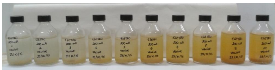
Figura 26. Sequência operativa de eletrocoagulação com eletrodo de ferro
