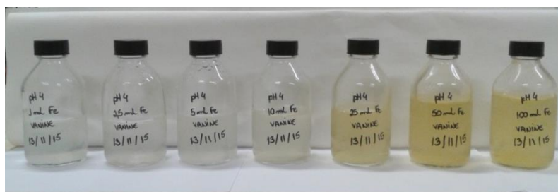
Figura 21. Sequência operativa de coagulação química com cloreto férrico em pH 4.
