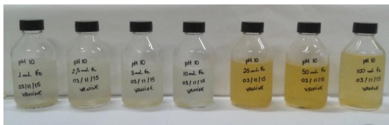
Figura 23. Sequência operativa de coagulação química com cloreto férrico em pH 10.
