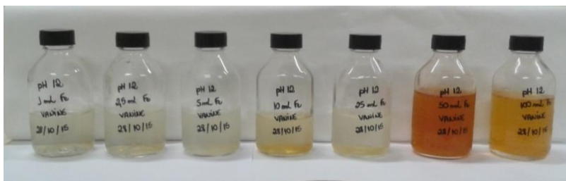
Figura 24. Sequência operativa de coagulação química com cloreto férrico em pH 12.
