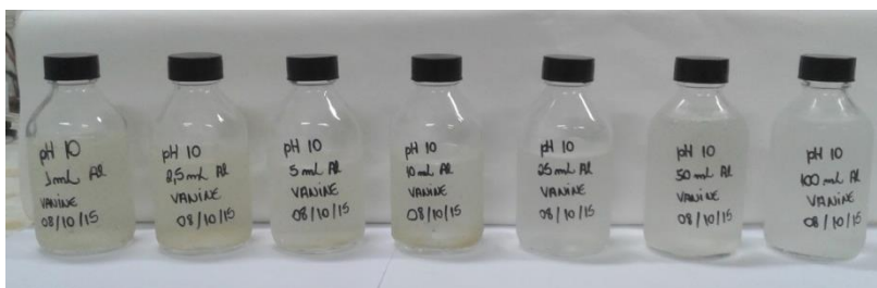
Figura 16. Sequência operativa de coagulação química com sulfato de alumínio em pH 10.
