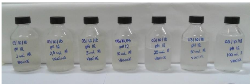
Figura 17. Sequência operativa de coagulação química com sulfato de alumínio em pH 12.
