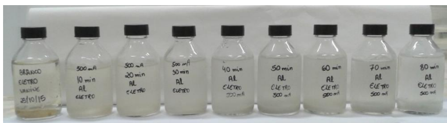
Figura 32. Sequência operativa de eletrocoagulação com eletrodo de alumínio.
