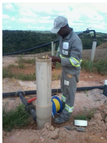
Figura 5-17 – Ajuste do sensor no dreno
