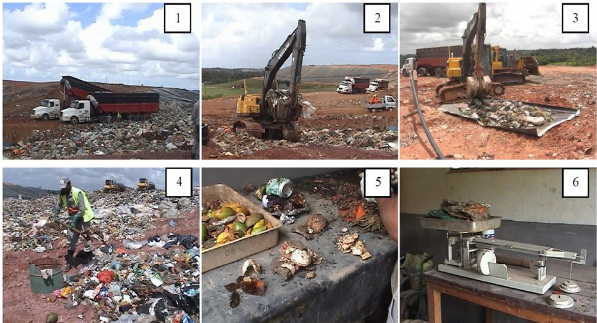
Figura 4-13 – Processo de caracterização dos RSN no ASMC.
