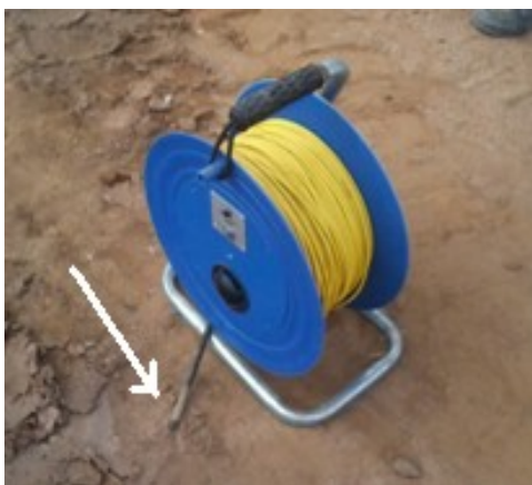
Figura 5-14 – Medidor de nível – destaque para sensor.
