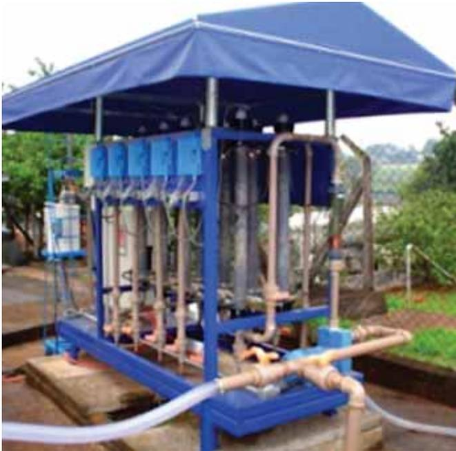
Figura 3: Sistema fotoeletroquímico para tratamento de efluente hospitalar, instalado no Hospital das Clínicas da Unicamp, Campinas.
