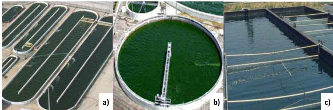
Figura 4.2. Três tipos de sistemas abertos de produção de microalgas. (a) lagoas tipo pista, (b) lagoa tipo circular, (c) tanque aberto.
