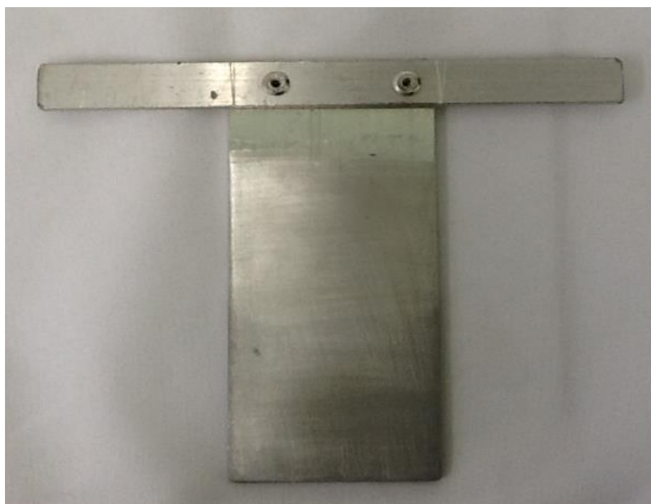
Figura 17 - Eletrodos de alumínio utilizado na eletrocoagulação.
