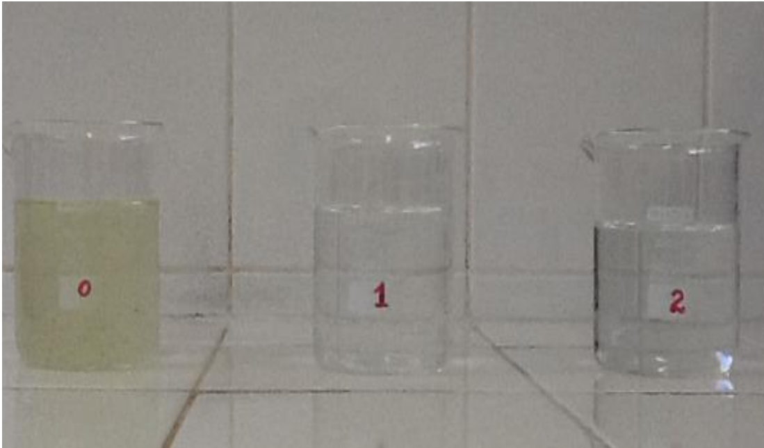
Figura 35 – Aspecto do efluente após tratamento por EC (1 e 2) e efluente bruto (0).
