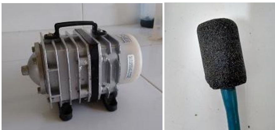
Figura 4.15 – Sistema de aeração dos reatores em escala de bancada
