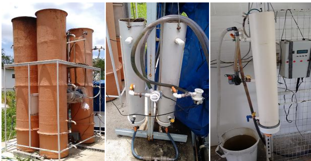
Figura 4.2 – Sistemas RBS operados em escala piloto (esquerda) e de bancada (meio e direita)
