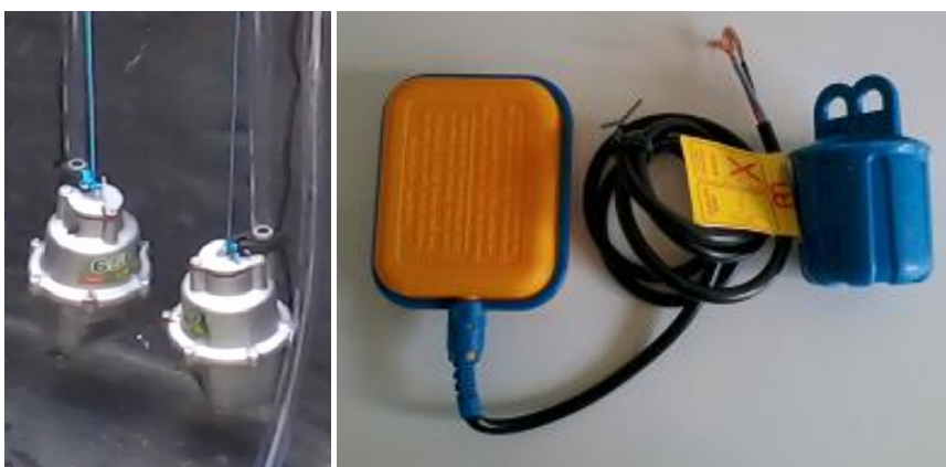
Figura 4.5 – Bombas submersas (esquerda) e boia elétrica (direita) utilizadas para alimentação dos reatores
