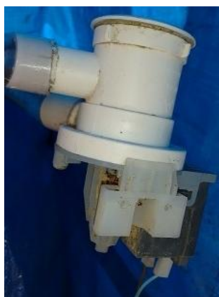
Figura 4.11 – Bomba de recirculação do sistema N/D escala piloto
