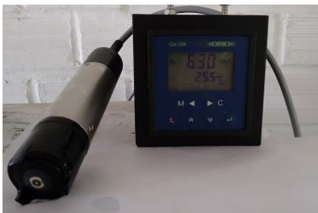
Figura 4.10 – Sensor e controlador de OD utilizado no sistema SND
