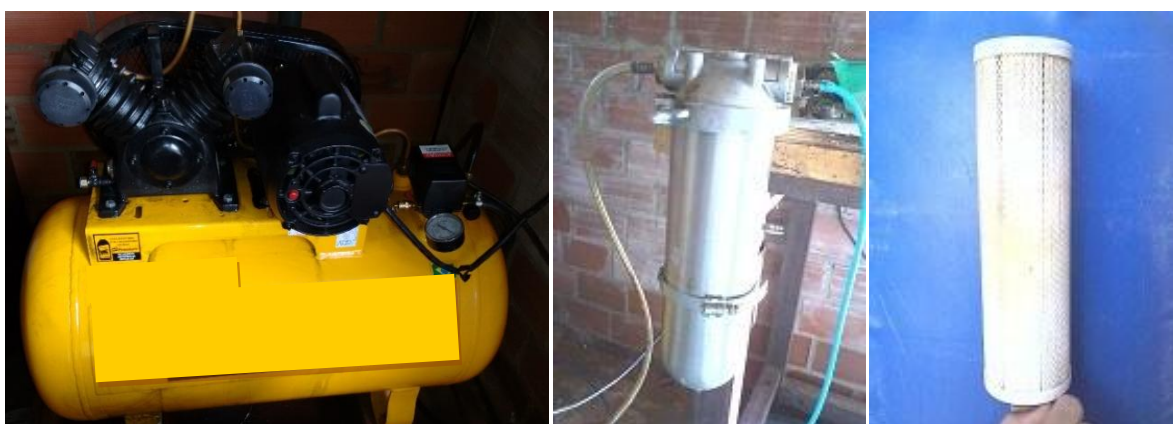
Figura 4.7 – Conjunto compressor/filtro como fonte de oxigênio para os sistemas
