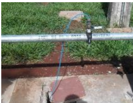
Figura 13 – Analisador de gases instalado e ponto de coleta de gás para análise.
