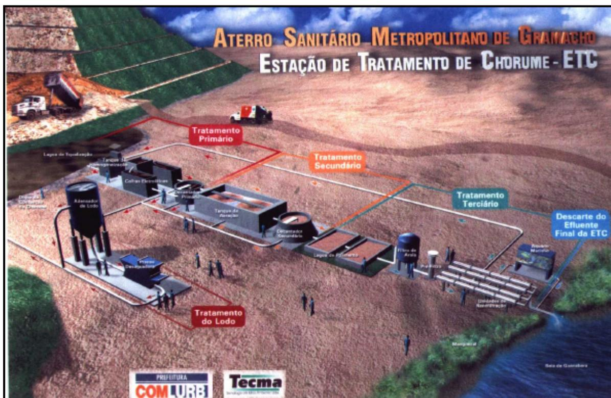
Figura 1: Configuração da Estação de Tratamento de Chorume de Gramacho
