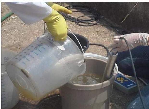
**Figura 4.17:** Medições para composição de hidrogramas e polutogramas
