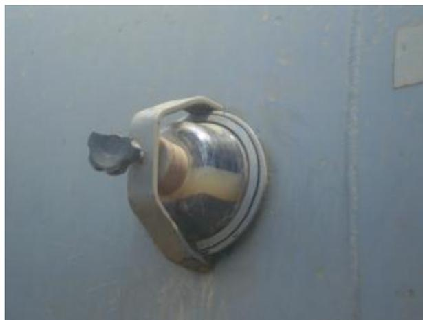
**Figura 4.11:** Dispositivo para visualização do lodo dentro do caminhão limpa-fossa
