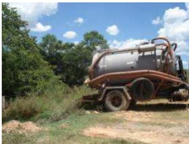
**Figura 3.1:** Caminhão limpa-fossa de município com mais de 70 mil habitantes, em Minas Gerais, durante o despejo do lodo de tanque séptico em córrego
